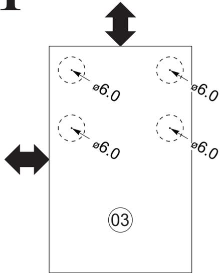
Posicionar o painel acima da cômoda ou em outro lugar desejado e utilizar os furos do próprio painel como gabarito para fazer os furos  $\varnothing 6\text{mm}$  na parede.
