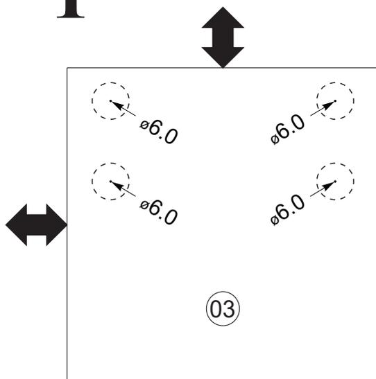
Posicionar o painel acima da cômoda ou em outro lugar desejado e utilizar os furos do próprio painel como gabarito para fazer os furos  $\varnothing 6\text{mm}$  na parede.
