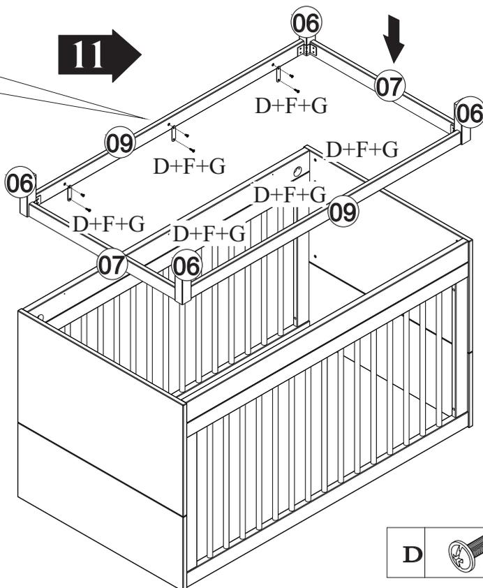
**Nota:** Para fins de armazenamento, transporte e ou mudança de função as ferragens (letra F e letra G) permanecerão fixadas na barra (peça 05).
